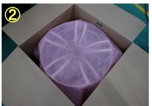
②乾燥後、表面に傷がつかない ように不織布を被せ保護する。
