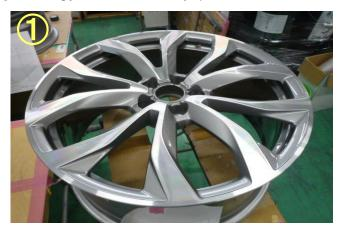
①表面傷を修理し、塗装行う。 その後、約1日乾燥させる。
