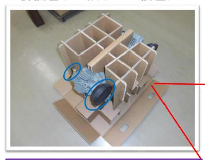
製品の固定は、本体(鋳物部分)の強度の強い部分のみを強化段ボールで押さえている。
