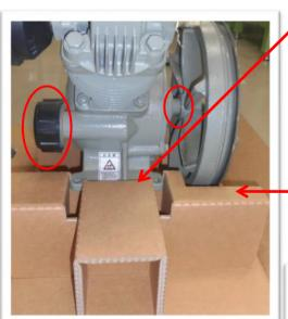
底パッドに製品の強い部分の固定台部が前後に固定される様に段差のある構造とした。
