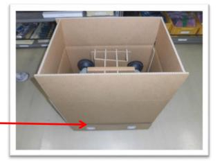
短手は被せる段ボールの内側に入れて 長手面のジョイントは4か所のみとし、作 業者の工数を低減。
